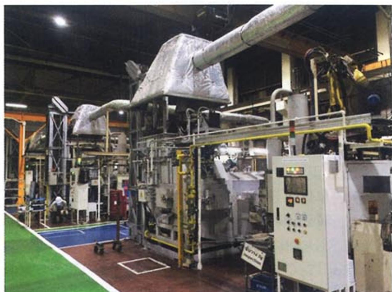
図3 酸化物の抑制炉
