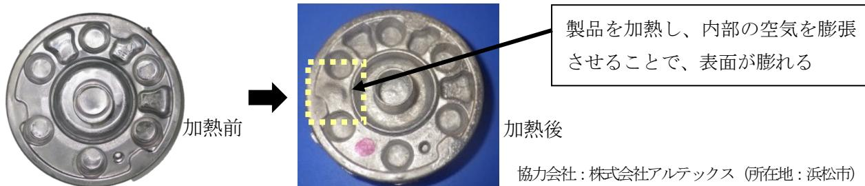
従来の検査では、装置内で熱風を循環させて製品を加熱する方法などが採用されていましたが、製品を約20～30分加熱する必要があり、生産性向上を実現するために、加熱時間の短縮が求められていました。
