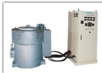
エレクリンキーパーは、「高精度の温度制御」「排気ガスの発生防止」を実現した当社開発の保持炉です。
