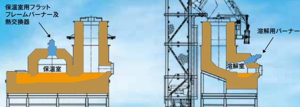
フリーダム<sup>®</sup>は、溶解室には高効率のバーナーを、保温室にはフラットフレームバーナーと熱交換器を採用しております。これらの相乗効果により、炉内の雰囲気温度を下げ、かつ炉内の残留酸素濃度を抑制し、わずかな清掃回数(年1~2回程度)で済むレベルまで酸化物の発生を抑えることを実現。ユーザー様よりご好評をいただいております。
